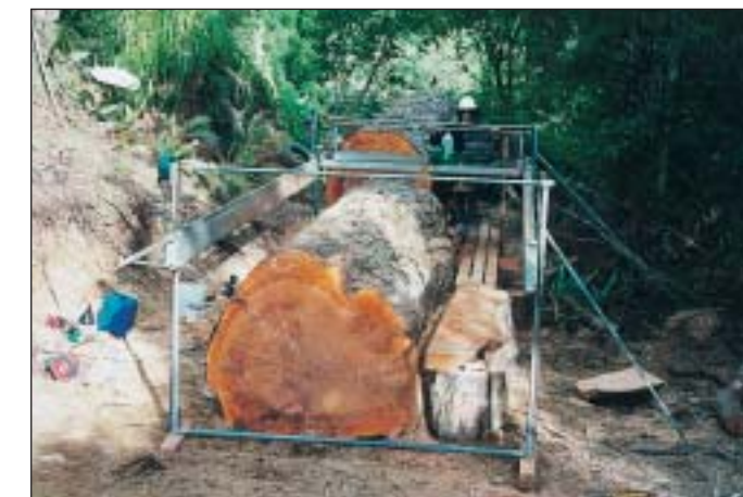
Pode ser montada em qualquer terreno. A armação da serra é facilmente alinhada com a tora.
