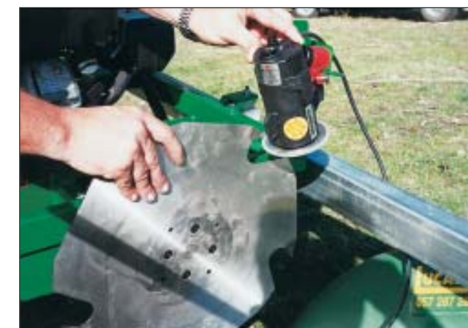
Afiação rápida sem tirar o disco da serra. O aparelho usa a bateria do motor da serra.
