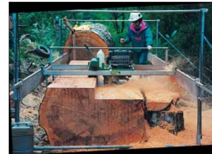
A serraria segue a bitola com menos de 1mm de desvio, mesmo acertando nós ou grão adverso.
