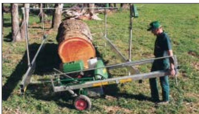
Rodas removíveis facilitam a movimentação da serra.
