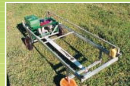
Serra para pranchas com motor próprio.
