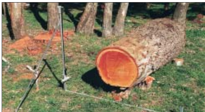
A serraria e montada em cima da tora.
